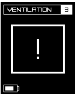
Meldung "Lüftung defekt"
