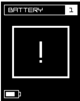
Meldung "Batterie defekt"
