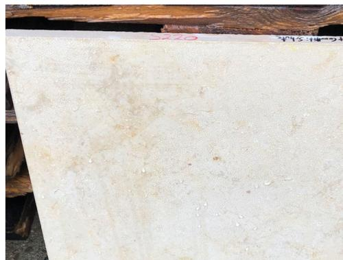
**Abbildung 2:** Platte (tellergestrahlt) mit AKEMI® Anti-Graffiti nach der Reinigung mit Dampfstrahler und **AKEMI® Graffiti-Entferner**
