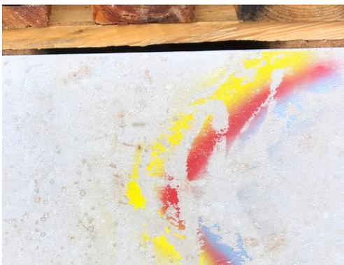
**Abbildung 1:** Platte (tellergestrahlt) ohne AKEMI® Anti-Graffiti nach der Reinigung mit Dampfstrahler
