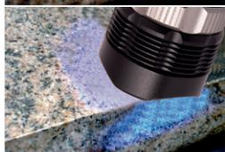
Mit **AKELUX** Sichtfolie bedecken und mindestens 2 Minuten mit **AKELUX** LED-Lichtstrahler BASIC aushärten.
