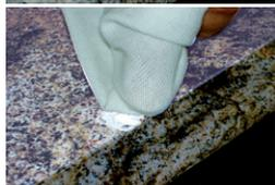
**AKELUX** Polierpaste auf den Stein auftragen. Manuell mit der Filzseite des **AKELUX** Schleif- und Polierblocks oder maschinell aufpolieren.
